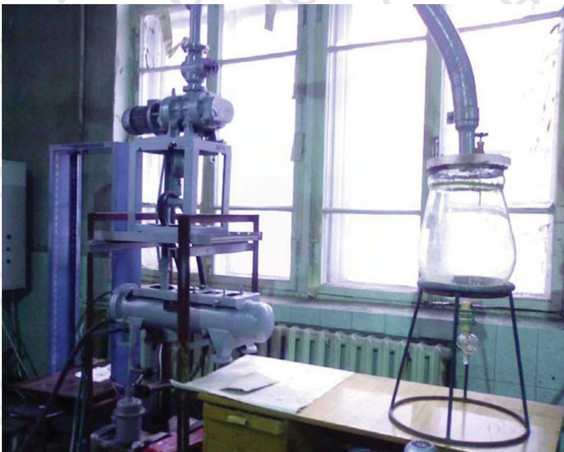
Вакуумная установка для получения цилиндрического массива водного льда методом послойного намораживания и последующего смораживания
